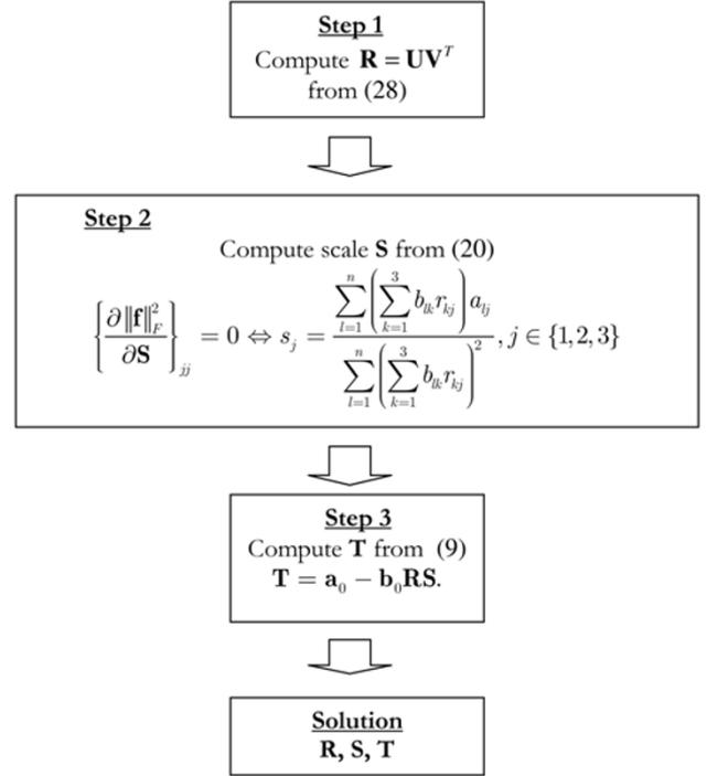
Fig. 1. Procrustean 9-parameter transformation algorithm.
